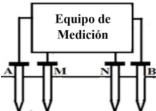
Figura 6. Geometría del Sondeo Eléctrico Vertical. Arreglo de Schlumberger
