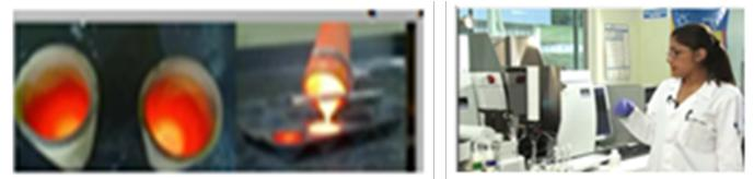
**Figura 6.** Ensaye a fuego a la izquierda a), y por absorción atómica a la derecha b).
