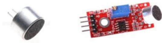
**Figura 2.** En la parte izquierda se muestra el micrófono de condensador, y en la derecha el sensor acústico de alta sensibilidad, donde se puede observar el micrófono como componente.
