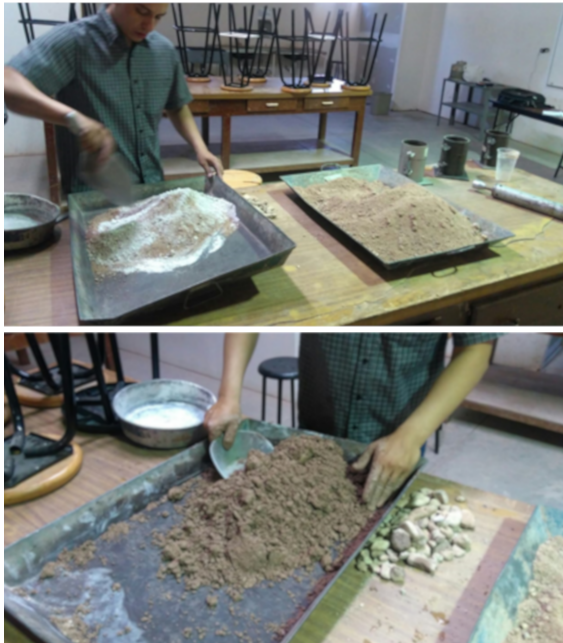
Figura 6. Homogenización de materiales en seco y aplicación de humedad.
