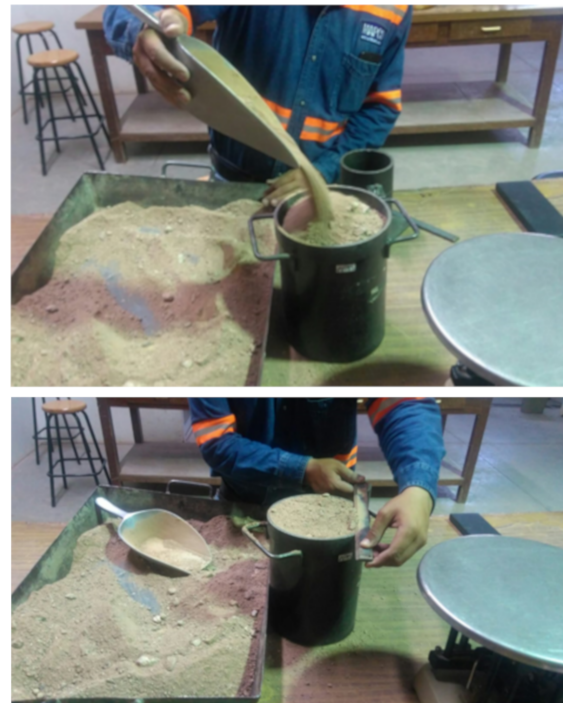
Figura 5. Técnica caída libre para obtener peso específico del material.
