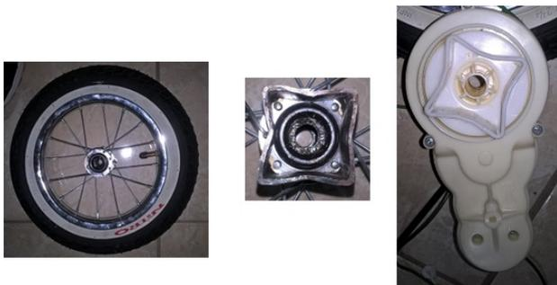
Figura 8: Llanta, Adaptador, Motor
