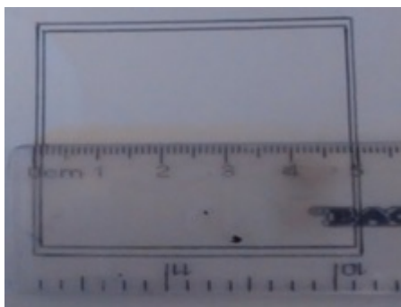
Figura 11: Cuadrado ejecutado en la CNC
