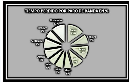
Figura 3. Porcentaje anual de paros en la producción de cobre de la empresa minera Buena Vista del Cobre relacionados con las bandas transportadoras analizadas en el proyecto.
