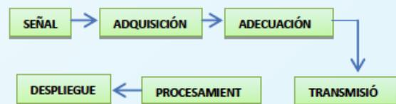
Figura 1. Diagrama a bloques de un medidor.
