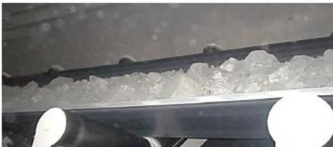
Figura 1. Banda transportadora de material previamente reducido para el segundo proceso de trituración.
