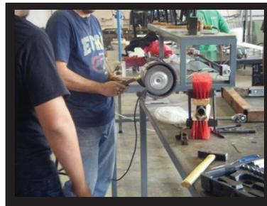
Figura 5. Estudiante rebajando pieza de madera con esmeril
