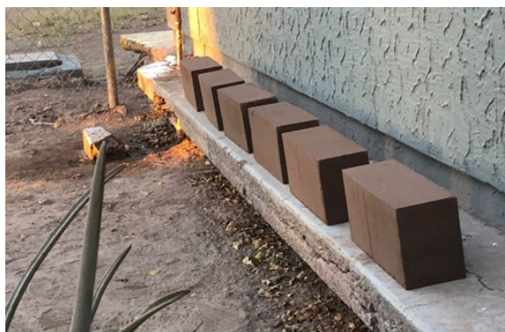
Figura 3. Bloques de Tierra Comprimida, Elaboración Propia.
