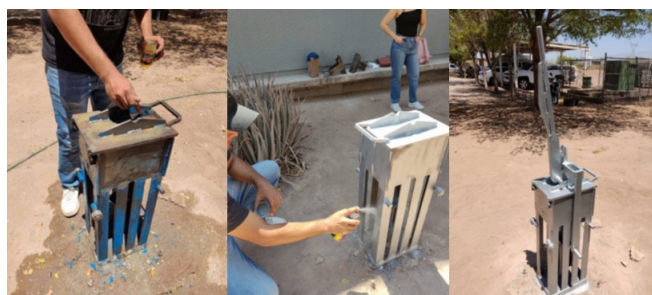
Figura 2. Máquina de elaboración de BTC adquirida por ITESCA.
