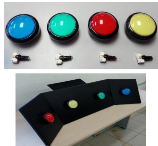
Figura 3. Tablero con Push Buttons integrados.
